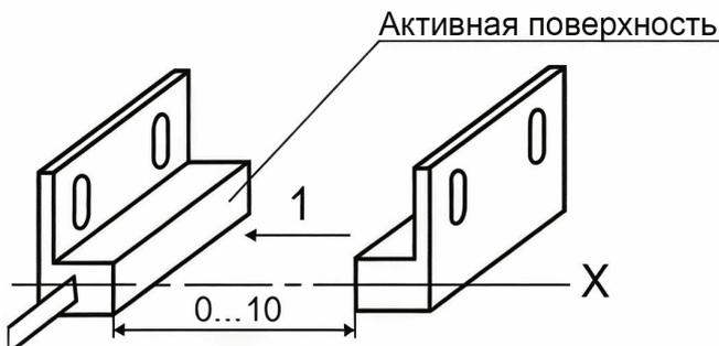
При нахождении датчика в зоне действия магнитного поля инициатора контакты геркона размыкаются и остаются в разомкнутом состоянии до тех пор, пока инициатор не выйдет из чувствительной зоны датчика.
